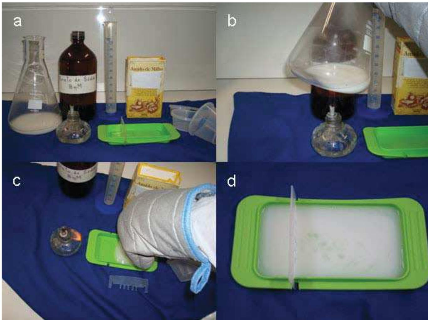
**Figura 3.** Montagem do gel de amido: **a.** Materiais necessários para o preparo do gel; **b.** Aquecimento do amido de milho; **c.** Colocação do amido de milho fervido na forma; **d.** Forma com gel esfriando.
